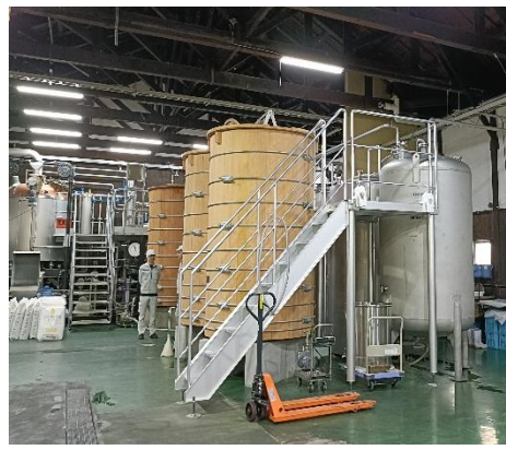
発酵槽：温度調整管理ができる最新の発酵槽と木製槽がありました
