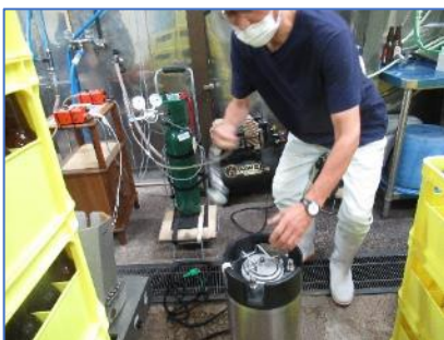
ボンベに詰めて振動を加え 炭酸ガスを溶け込ます
