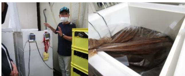
発酵槽 熱交換器を使い素早く冷却して酵母を投入
